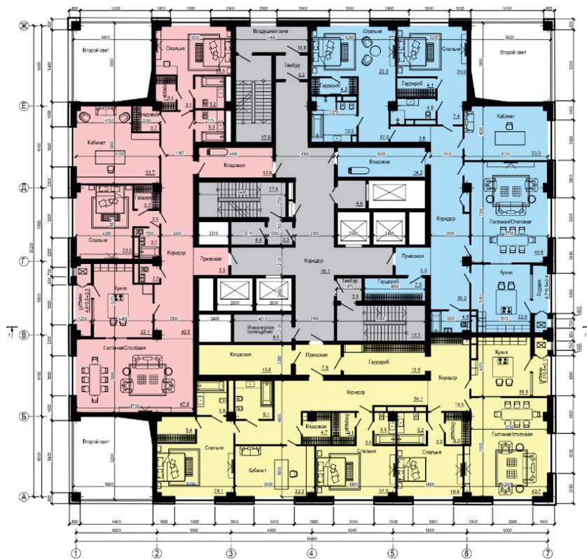
Рисунок 20. План типового этажа. Тип 2.
