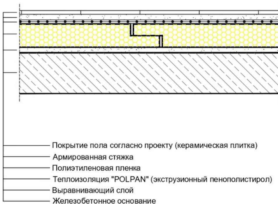
Рисунок 34. Узел 1, теплоизоляция перекрытия (по бетонному основанию).
